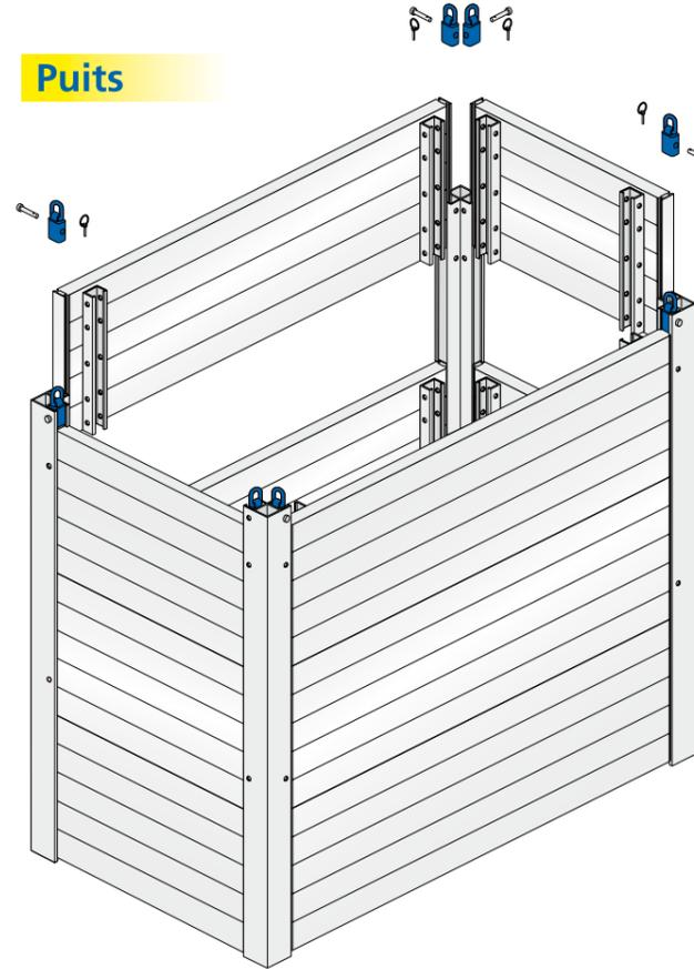
Panneaux  $t_{pl} = 60\text{mm}$
