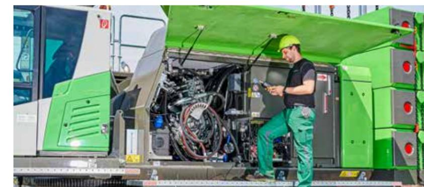
Le système de commande SENCON vous assiste pour établir le diagnostic et facilite le dépannage. Votre machine est ainsi rapidement à nouveau opérationnelle.
