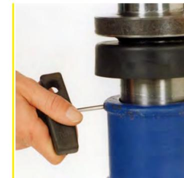
...et en dégageant la vis de sécurité par rotation,...
